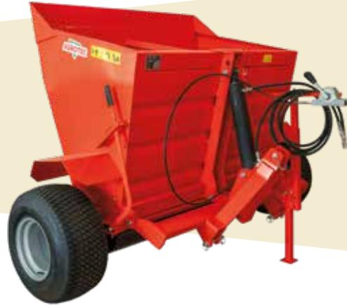
**DE** Die Anpassung der Bewegung der Räder und die hydraulische Kolben für die Verladung werden vom Steuerplatz aus geleitet und per doppelter hydraulischer Steuerung **mit doppelter Effektivität übertragen**.
